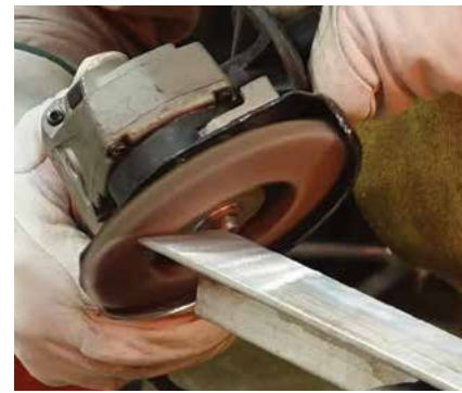
Biselado de una extrusión de aluminio, preparándose antes de soldar.
