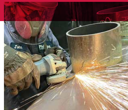
Desvanecimiento de soldaduras en un tanque de presión de acero inoxidable con un disco de desbaste Tiger Ceramic.
