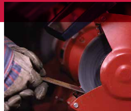
Limpeza de óxido de una pieza de acero al carbón con un cepillo circular de alambre ondulado.
