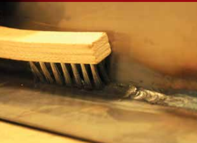
Limpieza de un cordón de soldadura con un cepillo manual.
